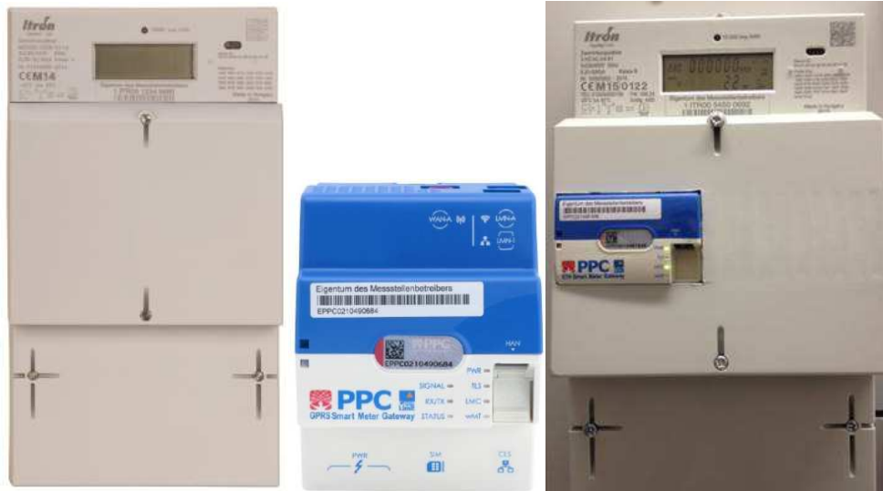
Abbildung 7: Basiszähler Abbildung 8: Gateway. Abbildung 9: Intelligentes Messsystem
