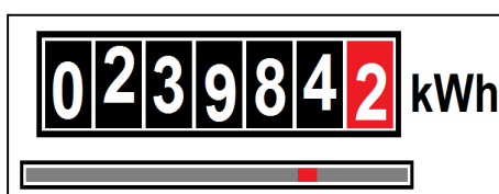
Abbildung 2: Zählerstandsanzeige bei herkömmlichem Ferraris-Zähler
